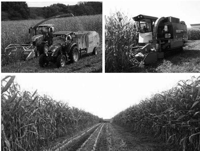
今年のデントコーンは発育も良く、非常に良好な状態での収穫となりました。毎年、(株)ヤンマーアグリジャパンに委託し、大型機械を持ち込んでいただき収穫してもらいます。今年は従来とは違い、刈取と細断、梱包が一つになった最新機械がやってきました(写真右上)。従来は、刈取と細断をする機械と梱包する機械が並走する形で収穫していました(写真左上)。運ぶ機械が1台で済むほか、小回りが利くうえ、細断したデントコーンが直接梱包部分に入るので、ロスが少ないように感じました。技術の進歩はすさまじいです。
