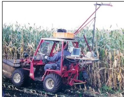
写真1 超音波センサを取り付けたTT33型トラクターでトウモロコシの草高を計測する様子
