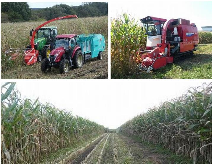
今年のデントコーンは発育も良く、非常に良好な状態での収穫となりました。毎年、(株)ヤンマーアグリジャパンに委託し、大型機械を持ち込んでいただき収穫してもらいます。今年は従来とは違い、刈取と細断、梱包が一つになった最新機械がやってきました(写真右上)。従来は、刈取と細断をする機械と梱包する機械が並走する形で収穫していました(写真左上)。運ぶ機械が1台で済むほか、小回りが利くうえ、細断したデントコーンが直接梱包部分に入るので、ロスが少ないように感じました。技術の進歩はすさまじいです。
